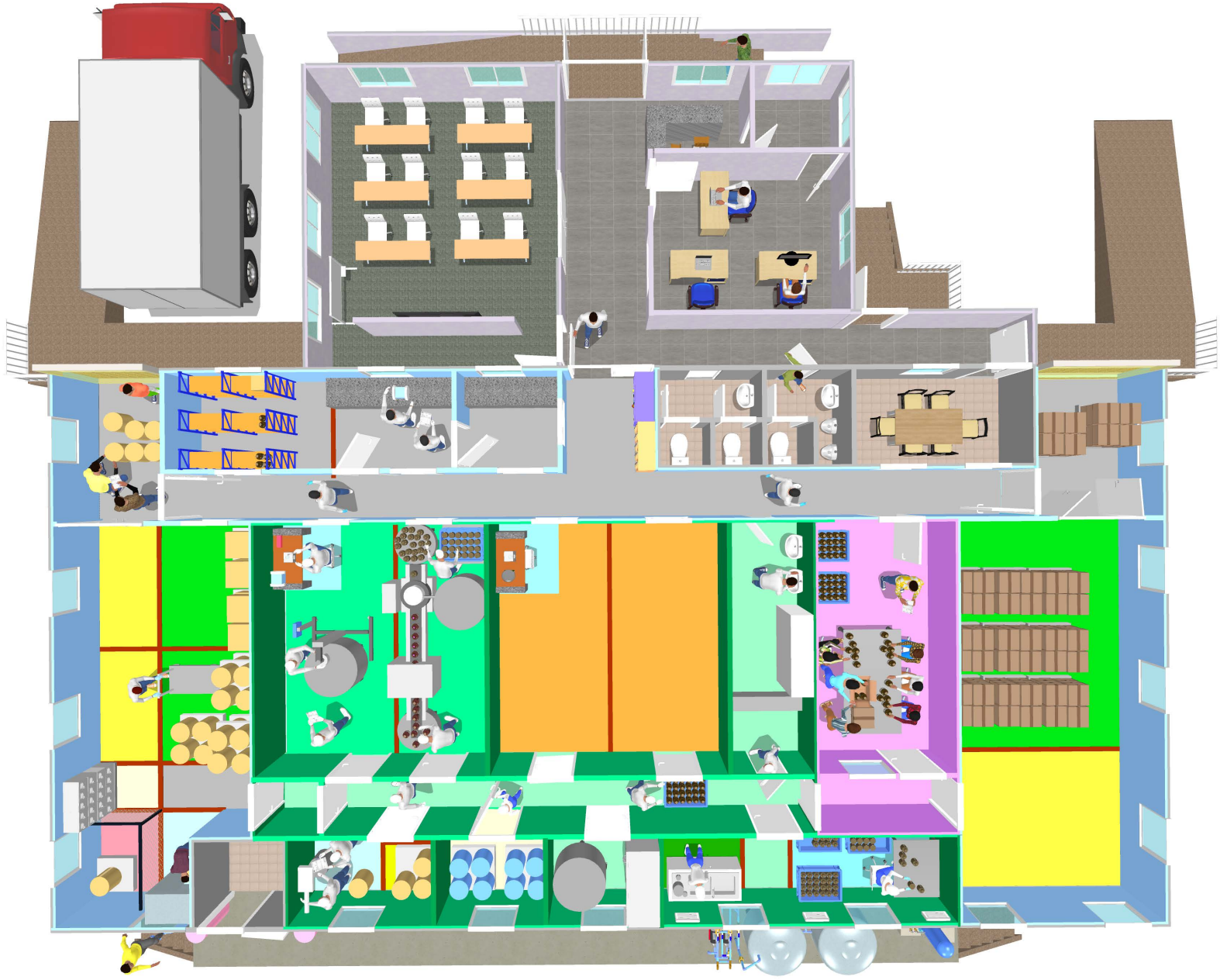
ตัวอย่างภาพสามมิติของแบบแปลนแผนผังที่ 3 ( U Shape ) แสดงแนวทางการจัดสิ่งอำนวยความสะดวก และจำลองกิจกรรมในสถานที่ผลิต
